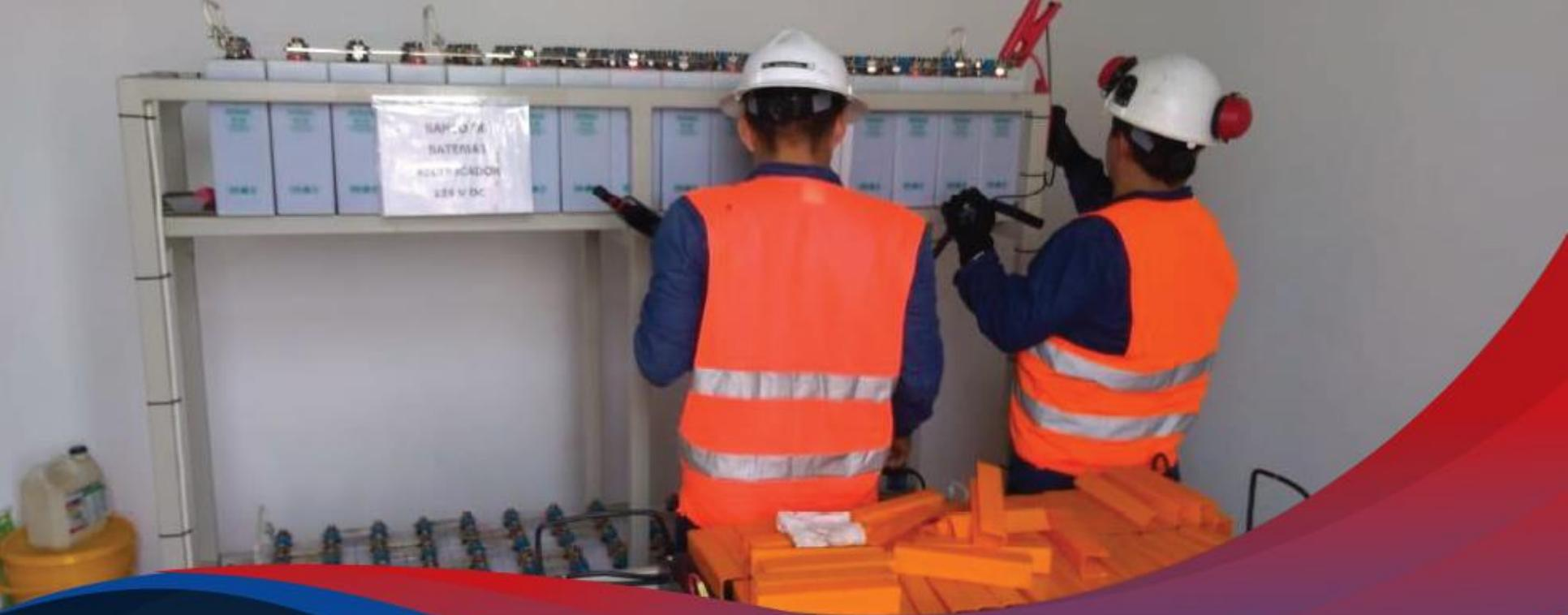
*Pruebas en línea para revisión del estado de las baterías de Plomo- Ácido y de NicD hasta 7000 A-h.*
